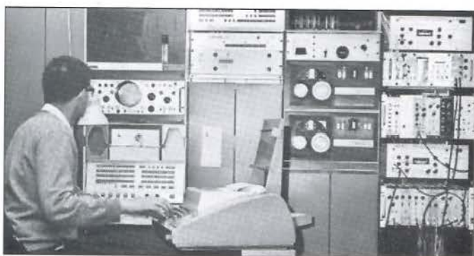
Figur 6. Finn Ingebretsen opererer PDP-7-installasjonen. Tilkoblingsenheterne er til høyre, og høyoppløsnings-pulsmåleren er øverst. Hyllene til høyre viser også vårt eget, enkle bus-system som i større målestokk ble erstattet av CAMAC-systemet.
